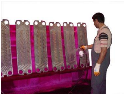
Prüfung der gereinigten Platten (Metal Check)
