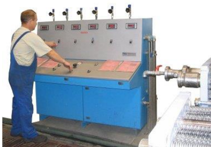
Druckprüfung des fertig rekonduktionierten Plattenpaketes
